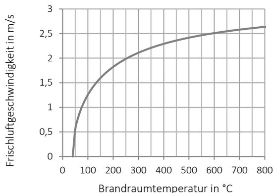
Abbildung 1: Frischluftvolumenstrom durch eine 2m hohe und 0,9m breite Tür in Abhängigkeit von der Brandraumtemperatur; John, R.
