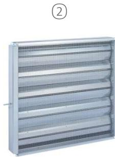
Isolierte Jalousieklappe mit Federrücklaufmotor, 24 V, stromlos öffnend, montiert auf der Saugseite des Gerätes.
